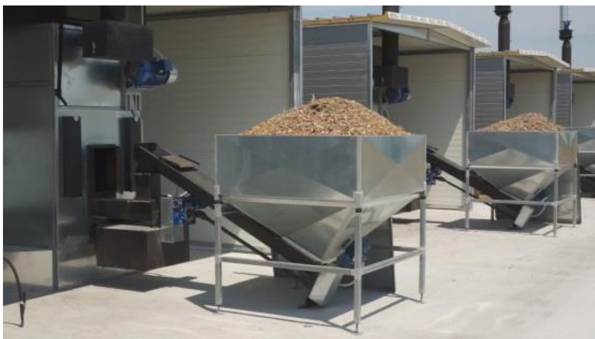
Slika 2. Termogen sa transporterom i košem (Izvor: Herbas d.o.o., https://herbas.hr/ )
