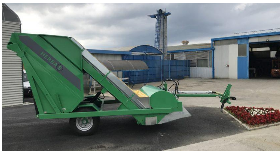
Slika 4. Kombajn za branje cvijeta kamilice (Izvor: Herbas d.o.o., https://herbas.hr/ )
